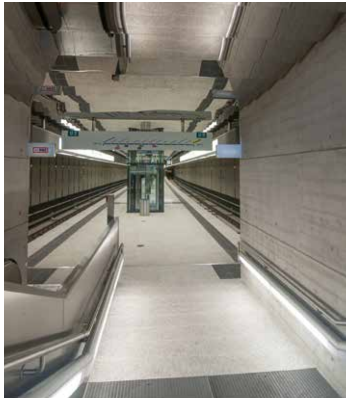
Abb.: Unterhalb der Handläufe befinden sich Lichtbänder des Typs »1079«. Foto: VAG - Andreas Neuer
